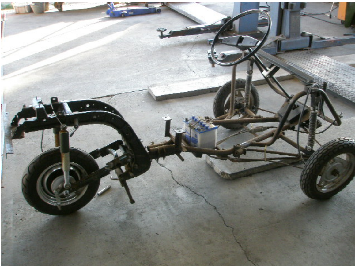
図3-4-6 改造中の小型自動車（モータ換装後のフレーム）
