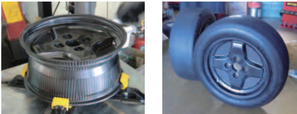
図 4-3-2 カーボンホイール（左：タイヤ装着前，右：タイヤ装着後）
