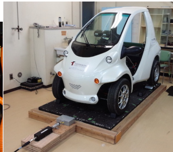
図1-2-2 EVへのワイヤレス電力伝送システム
