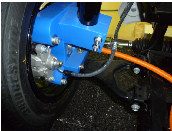
図1-2-1 試作したタイヤ集電機構
