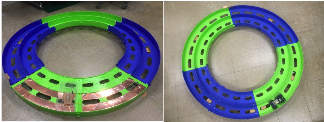
図 1-3-1 試作した左手系回路搭載電化レーン
