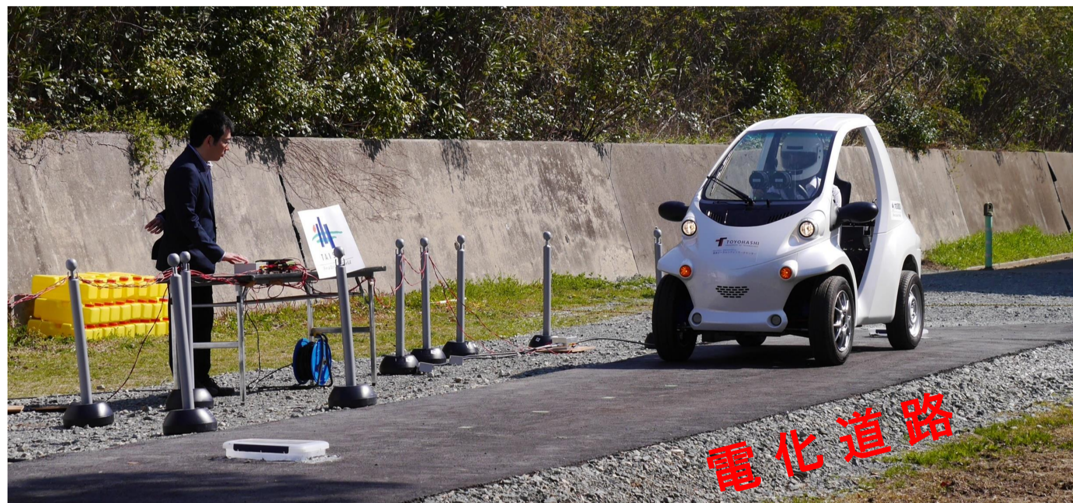
バッテリーレス電気自動車の走行実験 (大成建設(株)との共同研究)
