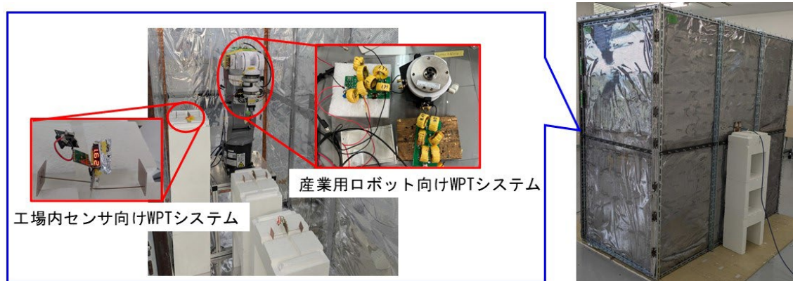
図 1-4-2 開発した工場内センサ向け WPT システム
